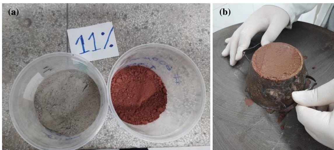
Figura 5.9: (a) RASRB 90 moído no moinho de bolas (b) Amostra de resíduo passante e retido na peneira #200 (c) amostra de todas as proporções de resíduo passante na peneira #200
