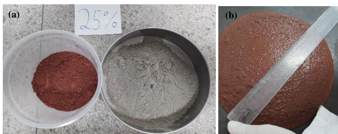
Figura 5.12: (a) Amostra de resíduo RASRB 90, passante e retido, na peneira #200 (b) espalhamento da pasta com RASRB 90– 25%
