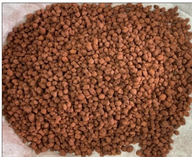
Figura 3.2: Agregado sintético de resíduo de bauxita.
