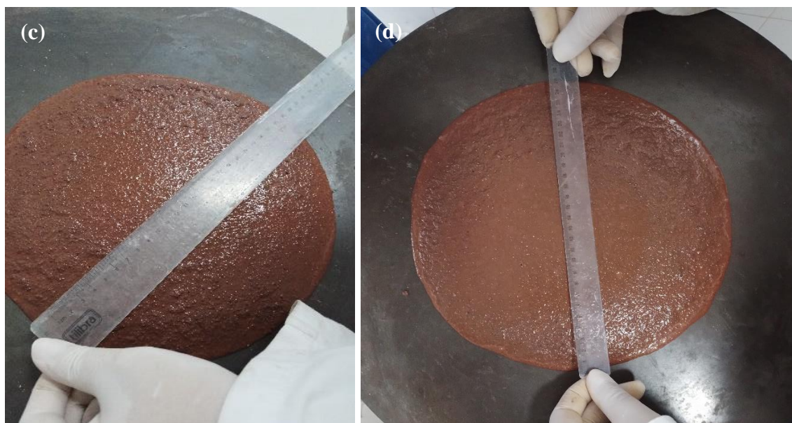
Figura 5.8: (a) Amostra de resíduo RASRB 80, passante e retido, na peneira #200 (b) desmoldagem do corpo-de-prova (c) e (d) espalhamento da pasta com RASRB 80 – 25%
